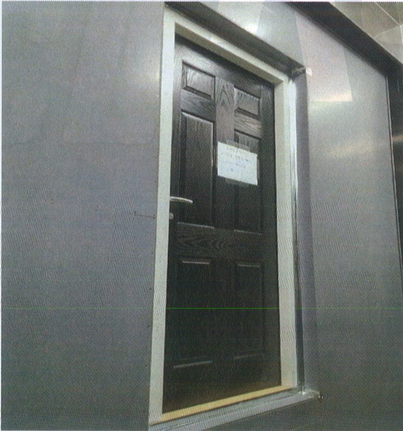
<사진 3> 항온측 시험체 모습 (열관류율)
