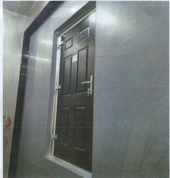
<사진 4> 저온측 시험체 모습 (열관류율)
